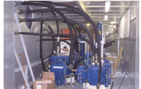
**60 mm Dämmung** an Wänden/Decke/Türen, hochwertige Ausführung der Innenverkleidung aus verzinktem Stahl-Glatblech 1 mm, sauber gestoßen, genietet
